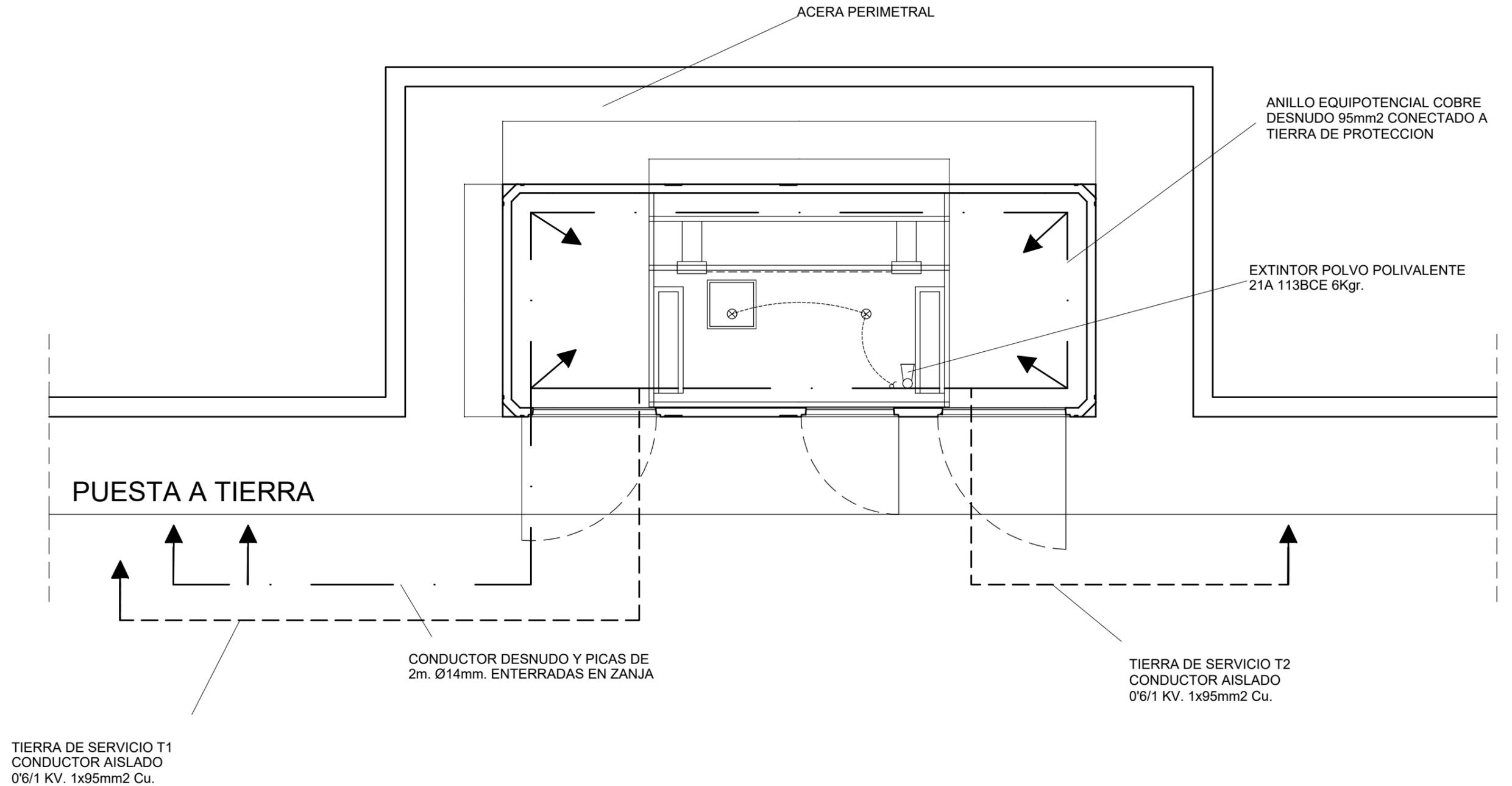
Dimensiones de la excavación 6500 x 3500 x 700mm
